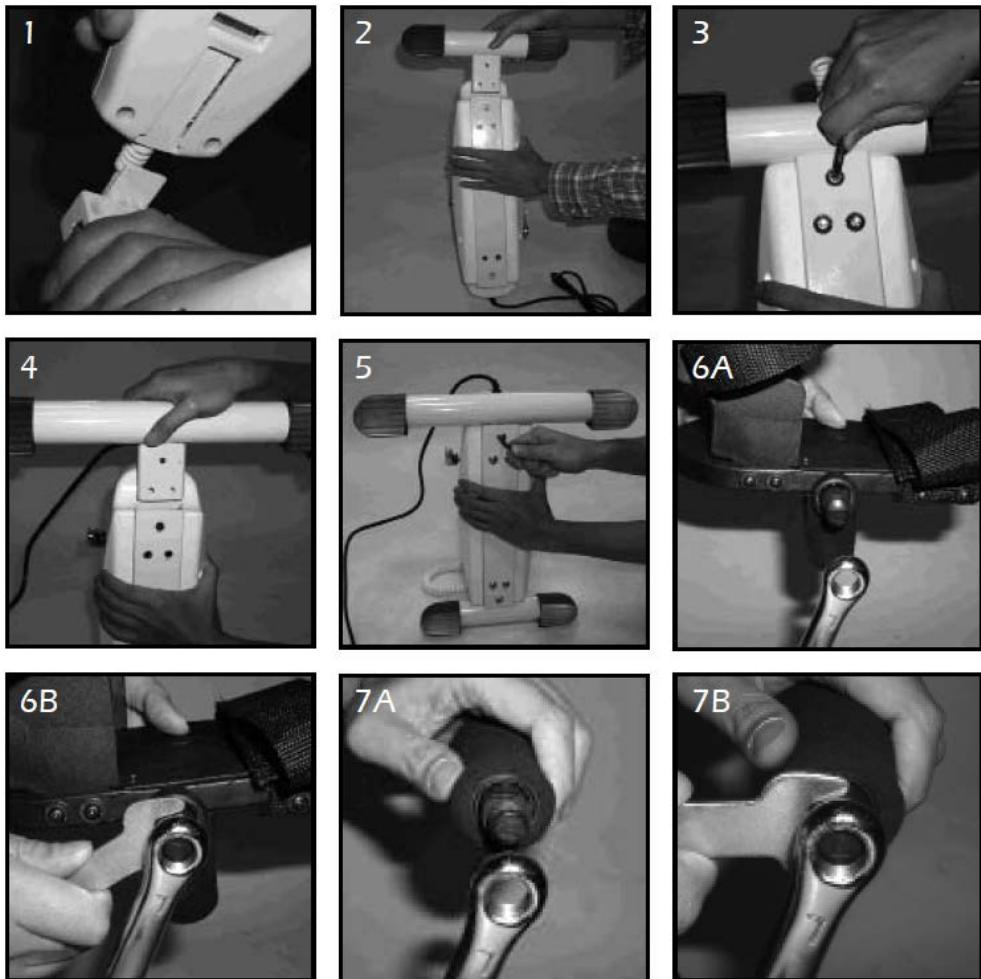
1. Κρατήστε τη συσκευή σε όρθια θέση. Η πλευρά του χειριστηρίου να βρίσκεται προς τα επάνω και το καλώδιο τροφοδοσίας εναλλασσόμενου ρεύματος προς τα κάτω. Τοποθετήστε τη μπροστινή βάση (3) στο κύριο πλαίσιο (4).
